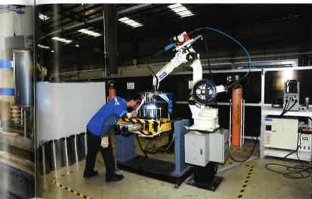
以機械手臂進行精密焊接技術，使熱水器內膽無縫，堅固耐用。
