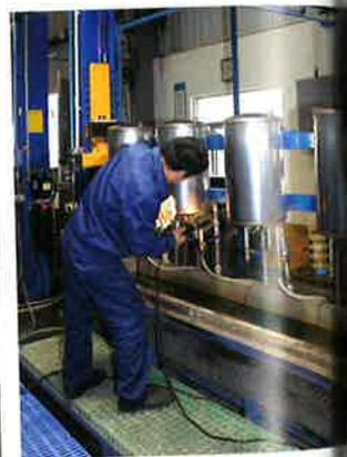
熱水器要經過內膽壓力檢測系統測試，確保安全。
