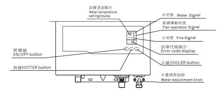
如出水溫度始終達不到設置溫度,則可適當調節"水量調節旋鈕",以使出水溫度達到設定溫度,順時 針調節水量減少,逆時針調節水量增大。
